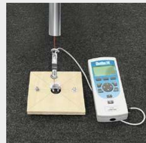
Тестирование прочности фиксаторов для ковриков
